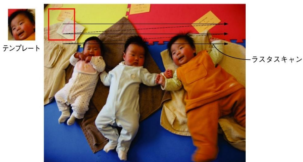
テンプレートマッチングにおけるテンプレートの移動
